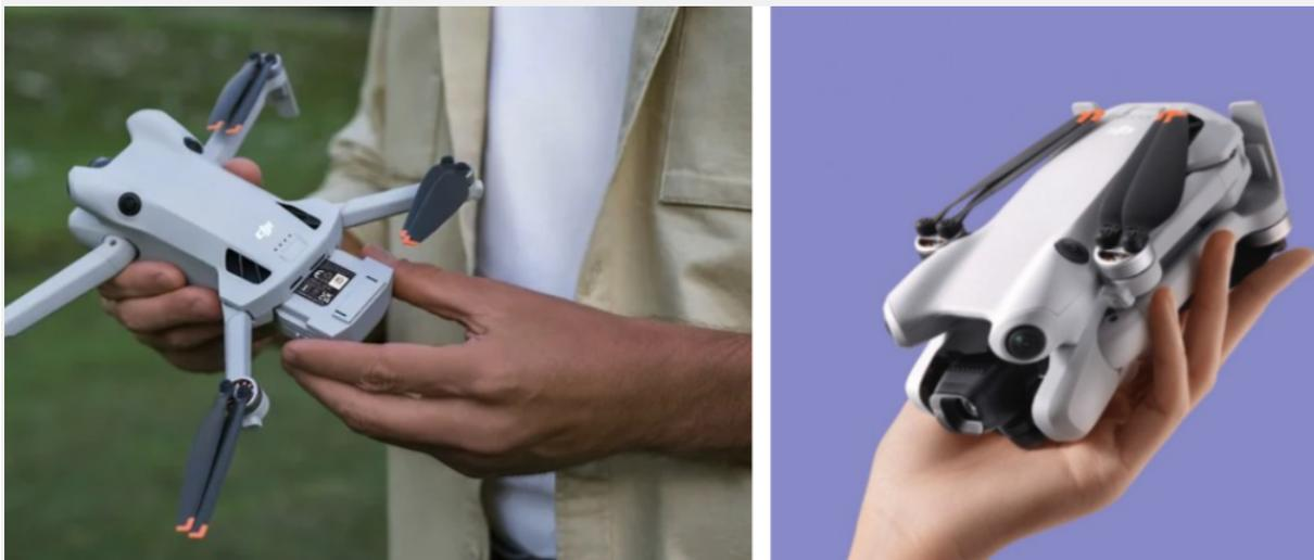
Особенностью новинки стала конструкция, позволяющая компактно складывать дрон для удобства хранения и транспортировки, а также масса 249 г, что освобождает владельца от необходимости регистрировать беспилотник. Беспилотник получил камеру 48 Мп с новыми алгоритмами обработки изображения, включая улучшенный режим Night Shots для съемки при недостаточном освещении.
