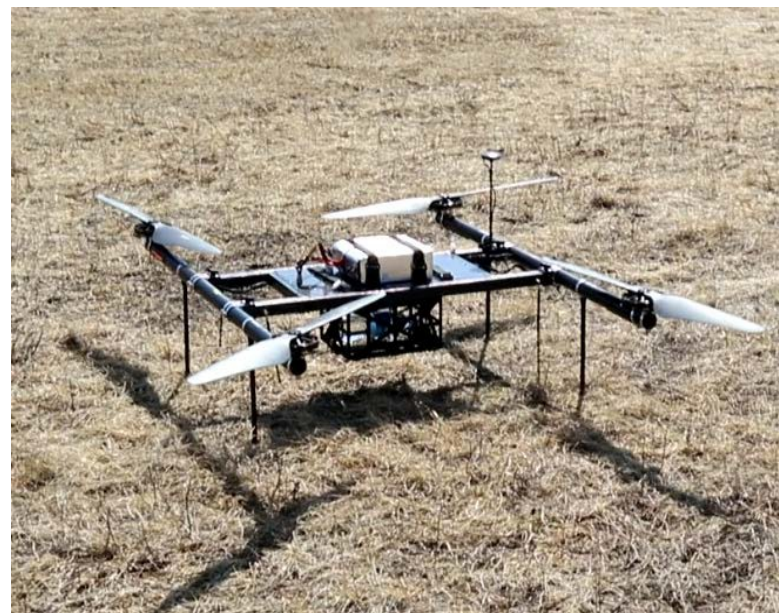
Квадрокоптер, оснащенный системой сброса груза, весом до 3 кг.
