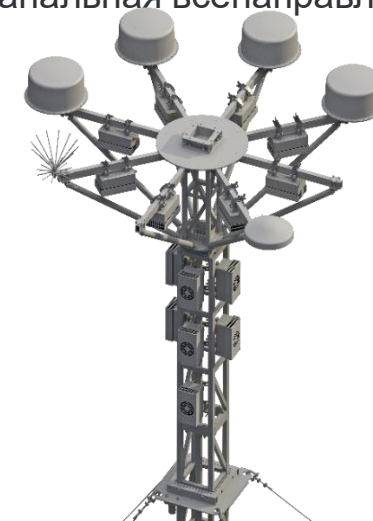
Внешний вид средства радиоэлектронного воздействия на КУПД и навигации БВС 15-канальная всенаправленная АФС
