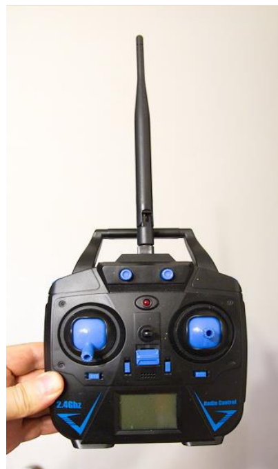
Пульт управления с доработанной антенной, увеличивающей дальность управления
