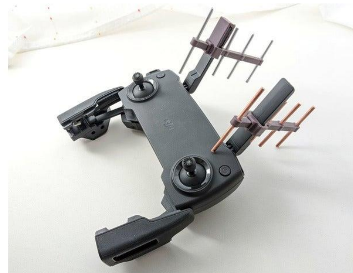
Пульт управления с доработанной антенной, увеличивающей дальность управления
