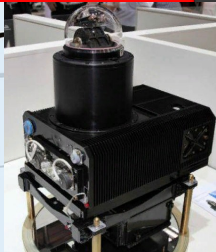
Лазерная станция оптико-электронного подавления комплекса «Президент-С»
