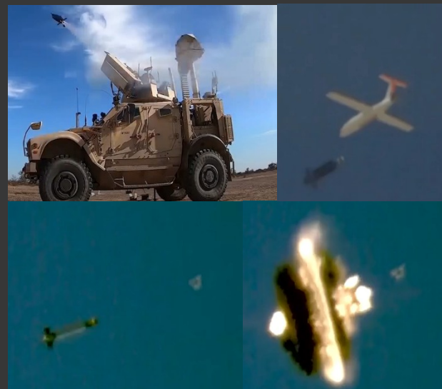
БВС-истребитель взрывного поражения, запускаемый из контейнера, установленного на автомобиле
