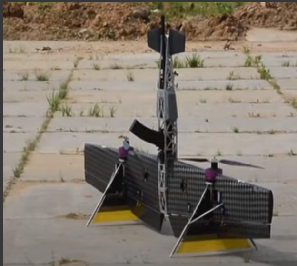
Дрон-истребитель вертикального взлета от МАИ (вооружен гладкоствольным автоматическим ружьем "Вепрь-12")
