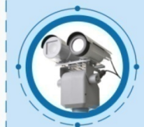
Видекамера и тепловизор на поворотной платформе
